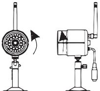
3. La modification des canaux se fait conformément au schéma avec le petit commutateur.
