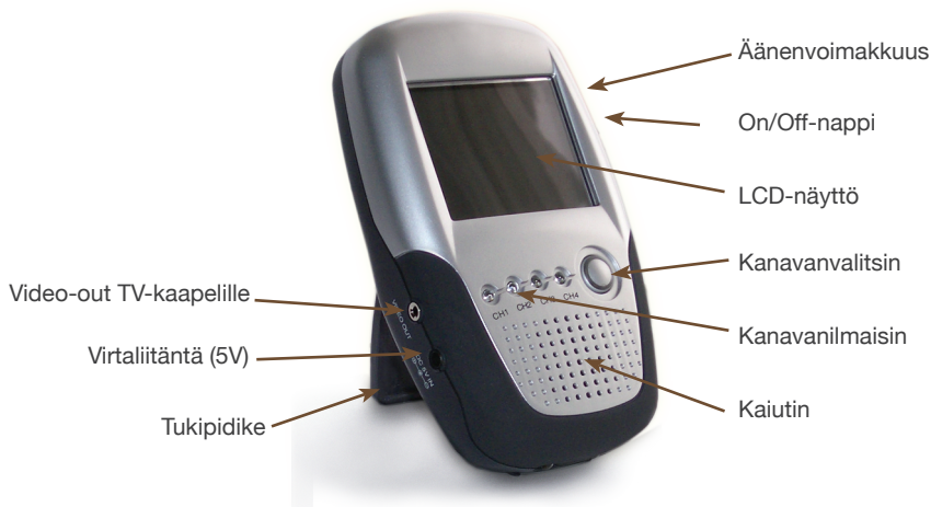
Langaton 2,5" LCD-näyttö (tuotenumero 711LCD)
