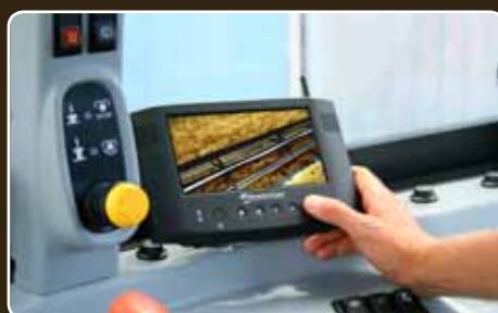
Interferenzfreie Sicht auf dem 7" LCD-Monitor.
